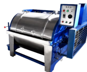
Imagen 2. Máquina industrial de scouring (lavado) de lana, utilizada en la eliminación de grasa, suciedad y materia vegetal de la fibra.
